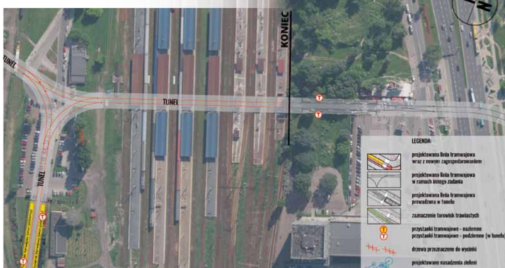
Schemat nowej linii tramwajowej przy Dworcu Zachodnim
